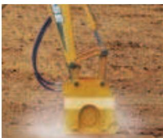
Comandos hidráulicos auxiliares (opcionales) permiten la utilización de una amplia gama de accesorios, tales como martillos rompedores, fresadoras de asfalto y compactadores.
