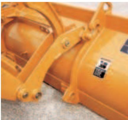
El enganche rápido permite al operador realizar el cambio del implemento de manera rápida y simple sin salir de la cabina.
