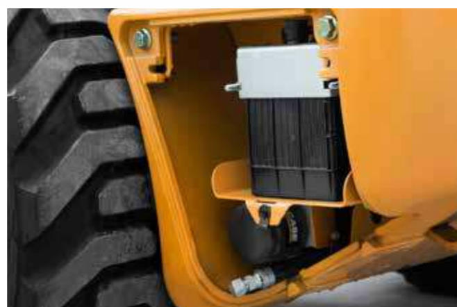
Snadný přístup k baterii a vypouštěcí hadici Baterie a vypouštěcí hadice jsou snadno přístupné z boční strany stroje. Po demontáži krytu umístěného za zadním kolem můžete snadno a pohodlně provádět rychlý servisní zákrok.
