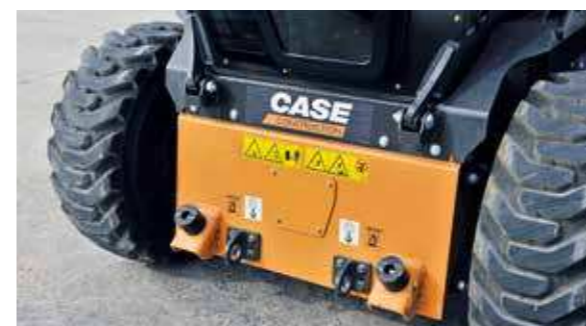
Tlačná síla díky zapření podvozku (šasi)!
