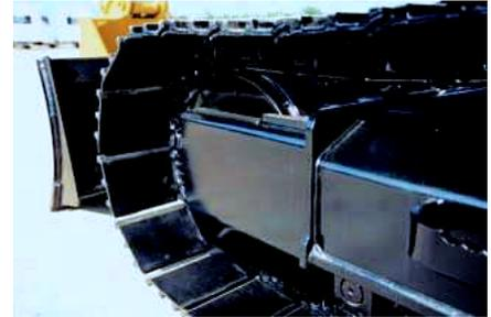
**Protector de la rueda guía.** El protector de la rueda guía, equipo estándar, es parte integral del bastidor de los rodillos inferiores. Este protector ayuda a mantener alineada la cadena durante el desplazamiento de la máquina o durante el trabajo en pendientes.
