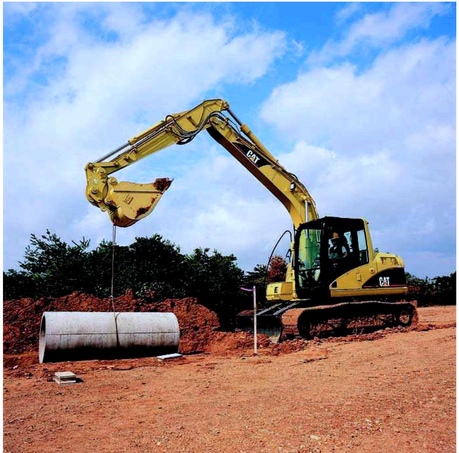
**Varillaje del cucharón.** El varillaje del cucharón de la 312C incluye el cilindro del cucharón, la biela y los eslabones hidráulicos.
