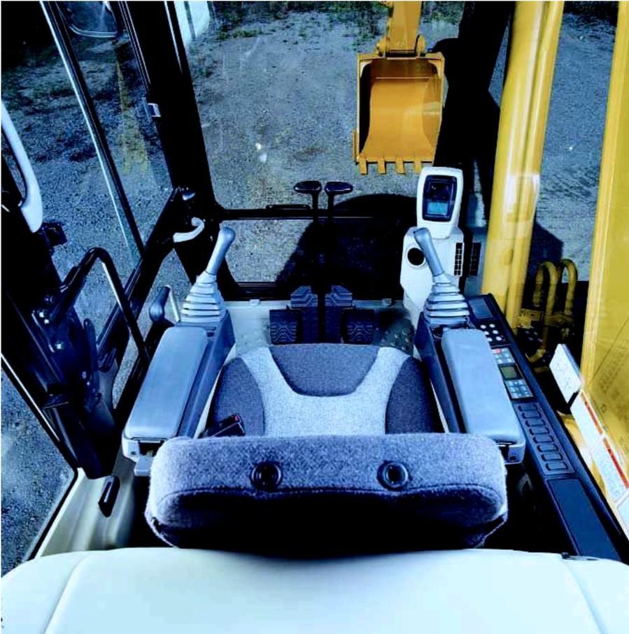
**Entorno del operador.** La estación de trabajo del operador de la 315C es silenciosa; los controles están ubicados ergonómicamente y tienen ajustes convenientes y requieren escaso esfuerzo de palancas y pedales, el diseño del asiento es ergonómico y la ventilación es altamente eficiente.
