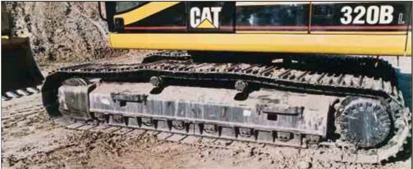
**Präzise Schweißung.** Durchgehende Automatschweißung gewährleistet gleichbleibende Qualität an allen kritischen Verbindungspunkten und bürgt für eine überragende Gesamtstabilität von Haupt- und Laufrollenrahmen.
