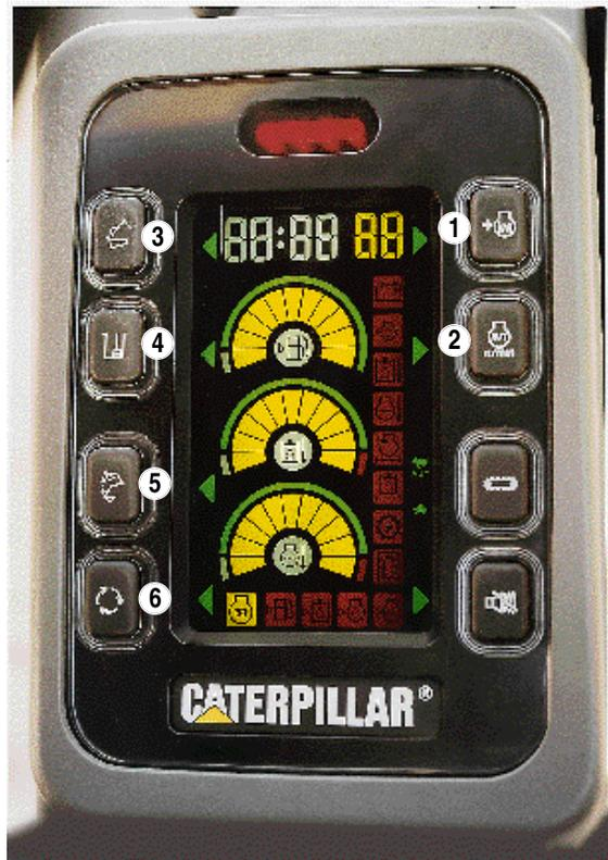
**4 Taste Drehwerkvorrang** – Vorgesehen für Einsätze, bei denen die Schwenkbewegungen im Verhältnis zu den Auslegerbewegungen überwiegen, also bei Arbeiten mit großen Schwenkwinkeln.
