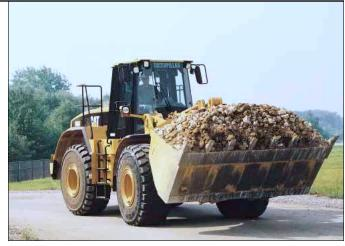
**Leiseversion.** Diese 966G-Variante ist zweimal leiser als die Standardmaschine und erzeugt einen Schalleistungspegel (Außengeräusch) von 106 dB(A) bzw. einen Schalldruckpegel (Innengeräusch) von 73 dB(A).
