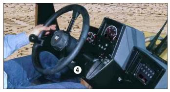
**Direktlenkung oder Normallenkung.** Der 966G ist mit zwei verschiedenen Lenksystemen lieferbar. Bei der Version mit Direktlenkung wird die Arbeitshydraulik mit einer elektrohydraulischen Vorsteuerung ausgerüstet, während Maschinen mit Normallenkung eine hydraulische Vorsteuerung besitzen.
