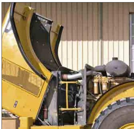
**Motorraumzugang.** Nicht nur die Kontur der Kunststoff-Motorhaube wurde verändert, sondern auch die Ober- und Seitenteile mit zusätzlichen Versteifungsrippen versehen. Beide Maßnahmen verbessern Stabilität und Dauerhaltbarkeit der Haube. Seitenklappen hinter den Reifen lassen sich hochschwenken und bei Bedarf komplett abnehmen. Die ausschwenbaren großen Kotflügel sind hinten angelenkt und erleichtern dadurch den Zugang zum Motorraum.
