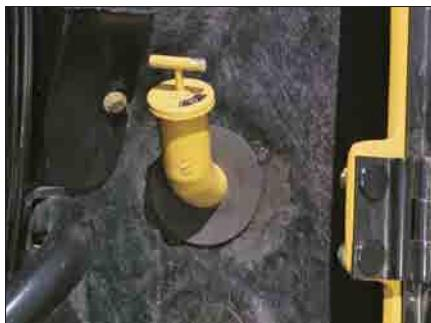
Geschützt hinter Seitenklappen platzierte Messstäbe und Schaugläser ermöglichen ein schnelles Prüfen der Motoröl- und Kühlmittelstände ohne die Motorhaube zu öffnen.
