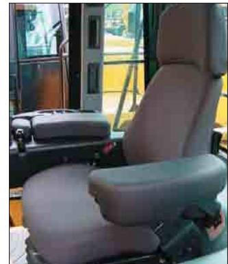
**Direktlenkung.** Äußerliches Merkmal der Direktlenkung ist das Halblenkrad mit integrierter Getriebeschaltung. Dieses System benötigt kein normales Lenkrad mehr, weil der Drehwinkel nur  $\pm 70^\circ$  beträgt und damit dem Lenkwinkel der Maschine entspricht. Daher entfällt bei der Direktlenkung das körperlich anstrengende Lenkradkurbeln.
