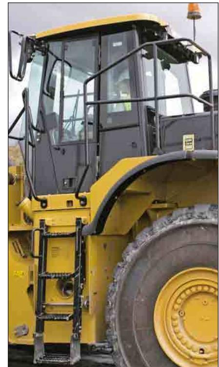
**Trittstufensatz.** Um das Reinigen der Frontscheibe zu erleichtern, ist ein Trittstufensatz erhältlich, zu dem auch zusätzliche Griffstangen und ein anklappbarer Außenrückspiegel gehören.
