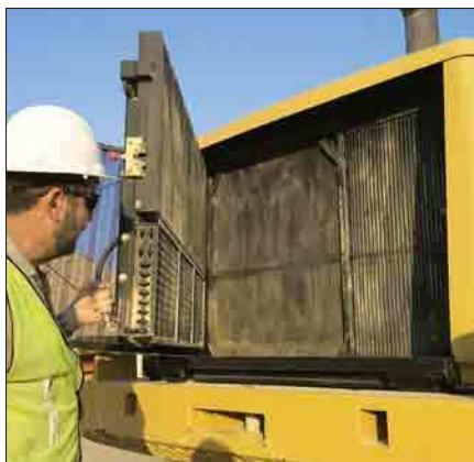
**Kühlsystem.** Ein feinmaschiges, gewelltes Siebgitter vermindert die Verstopfungsgefahr und kann zum Reinigen der Kühlernetze nach links geschwenkt werden. Kältemittel-Kondensator und Ölkuhler sind mit einer 45°-Schwenkvorrichtung ausgerüstet, sodass man den dahinterliegenden Wasserkühler mühelos erreichen und säubern kann. Hinzu kommen seitliche Klappen, die den Zugang zur Vorderseite von Wasserkühler und Ladeluftkuhler zusätzlich erleichtern.
