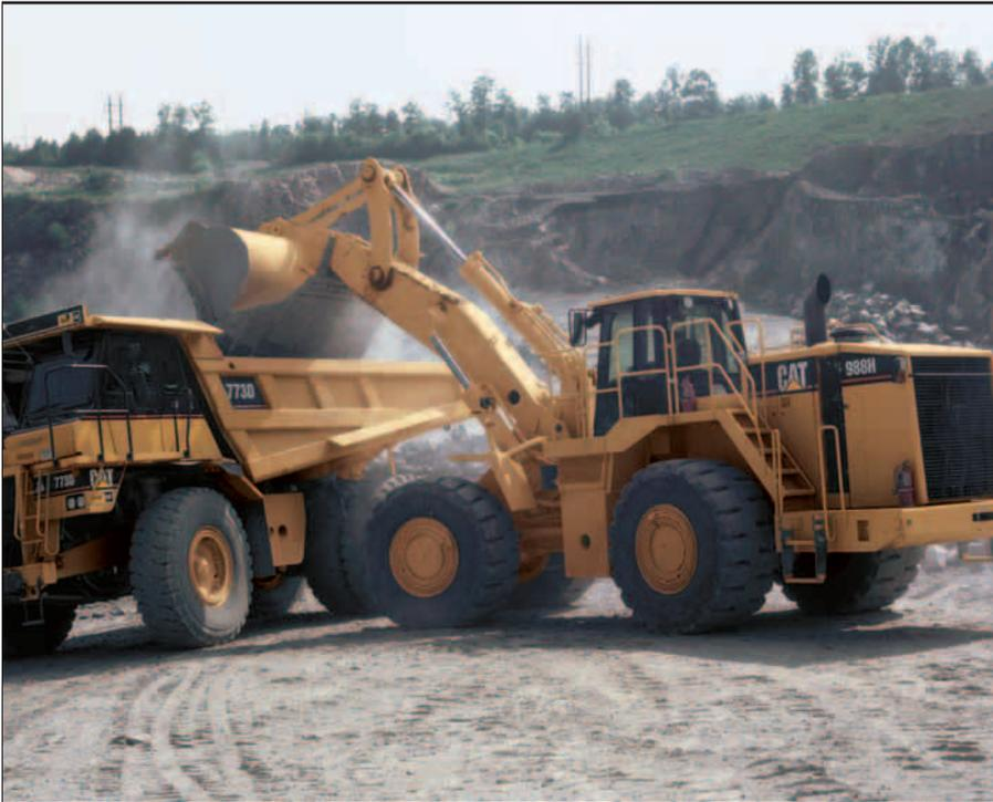
**Teambildung.** Beim Laden aus der Abbauwand oder von der Halde wird der 988H in der Regel im ersten Getriebegang gefahren. Wegen der vergrößerten Ausschütthöhe kann die Maschine jetzt zum Beladen von 33- bis 70-t-Muldenkippern eingesetzt werden. Dank gesteigerter Leistung und optimaler Anpassung an die vorhandenen SKWs wartet der vielseitige 988H mit besonders günstigen Kosten pro Tonne auf.
