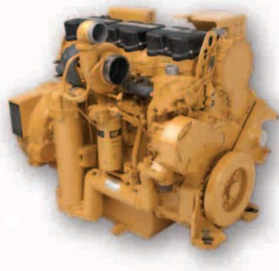
**1 Cat Dieselmotor C18 mit ACERT-Konzept** – Der schadstoffarme, elektronisch gesteuerte Sechszylindermotor C18 ATAAC MEUI folgt dem von Caterpillar entwickelten ACERT-Konzept und unterschreitet die verschärften Abgasemissions-Grenzwerte gemäß EU-Richtlinie 97/68/EG, Stufe III. Das in moderner Leichtbauweise konstruierte Zylinderkurbelgehäuse zeichnet sich trotz des geringen Gewichts durch hohe Verwindungssteifigkeit aus.
