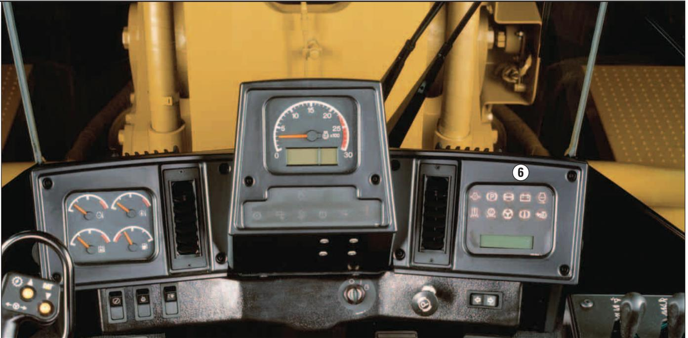
**6 Überwachungssystem** – Das updatefähige elektronische Caterpillar Überwachungssystem EMS III (Electronic Monitoring System) kontrolliert ständig die Funktion wichtiger Maschinensysteme. EMS III besteht aus drei Instrumentengruppen und verfügt über ein dreistufiges Warnsystem, das den Fahrer auf flüchtige und permanente Systemfehler aufmerksam macht. Infolge der Vernetzung mit den Steuergeräten von Motor, Hydraulik und Getriebe werden Fehlersuche und Reparaturen wesentlich erleichtert.
