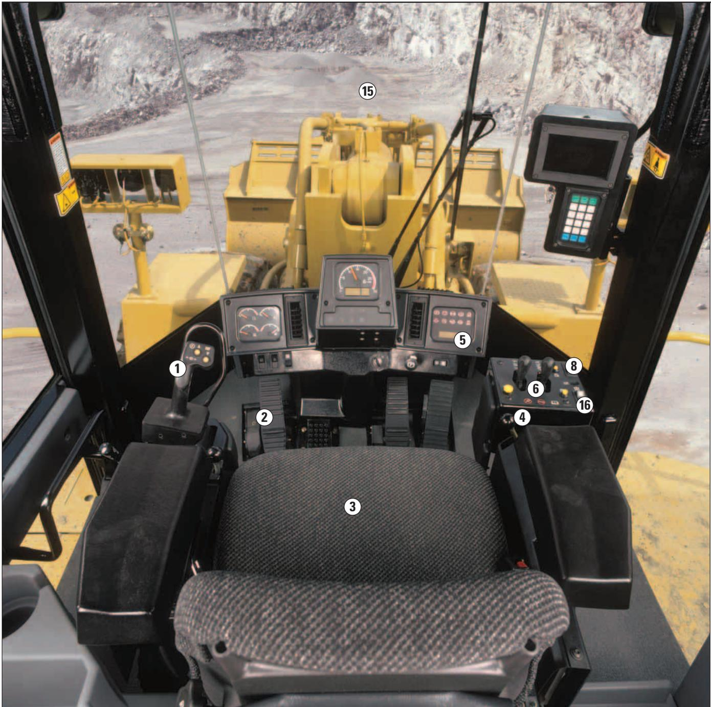
**Komfort.** Die Kabine mit einem Innenraumvolumen von 3,18 m<sup>3</sup> zeichnet sich durch beispielhaften Fahrerkomfort, ergonomische Bedienelemente, hervorragende Rundumsicht und niedrigen Geräuschpegel von unter 77 dB(A) aus. Für die persönlichen
