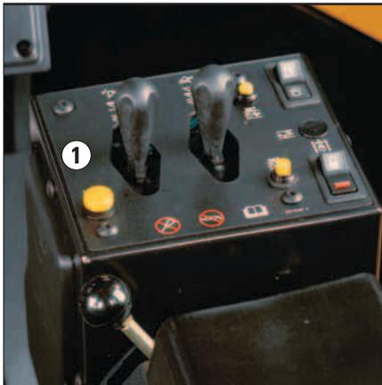
**1 Elektrohydraulische Steuerung –** Weil die praktischen Minihebel lediglich elektrische Signale an die auf dem Vorderwagen liegenden Vorsteuerventile senden, lassen sie sich spielend leicht, aber trotzdem feinfühlig betätigen. Caterpillar XT-3™ - und XT-5™ -Hochdruckschläuche machen Schlauchplatzer zu einer ausgesprochenen Seltenheit.
