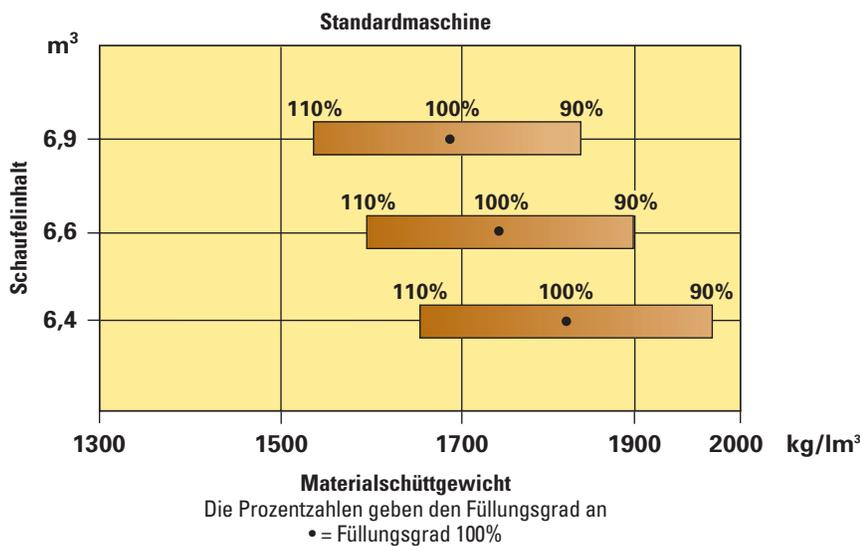
Die effektive Nutzlast hängt von der Ausrüstung des 988H ab. Ihr Caterpillar Händler berät Sie bei der Auswahl der richtigen Ladeschaufel für den vorgesehenen Einsatz.
