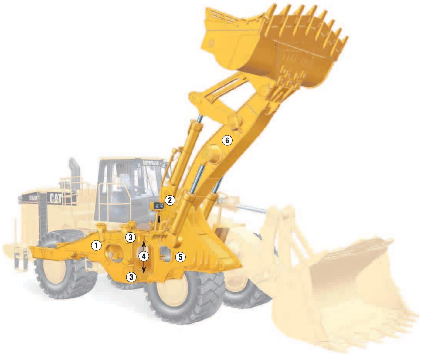
**Automatenschweißung.** Mehr als 90% der Schweißungen am Hauptrahmen des 988H werden durch Roboter erledigt. Die maschinellen Schweißnähte bieten den Vorteil stets gleichbleibender Qualität. Gussstücke in den kritischen Bereichen sorgen für zusätzliche Dauerfestigkeit, weil sie die auftretenden Kräfte optimal verteilen.
