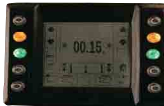
Дисплей системы лазерной нивелировки грунта AccuGrade
