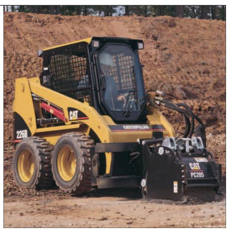
Fiabilité et propreté. La réduction des points susceptibles de fuir dans le système hydraulique améliore la fiabilité et accroît la propreté de la machine. De plus, l'huile hydraulique passe par un filtre à visser de 4 microns. Un indicateur de colmatage du filtre se trouve dans le poste de conduite. Un tamis de 74 microns monté dans le réservoir hydraulique empêche les débris plus gros de pénétrer dans le circuit et d'endommager les organes hydrauliques.
