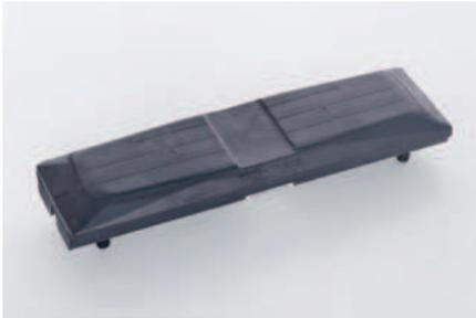
**Tacos de caucho.** La zapata estándar de la 314C CR tiene cuatro agujeros adicionales para la instalación de tacos de apoyo de caucho reforzados de acero. Los tacos de caucho optativos se fijan en las zapatas de la cadena, eliminando los posibles daños en las superficies pavimentadas. (Su distribuidor local puede instalar los tacos o los puede comprar a través del distribuidor para su instalación posterior.)
