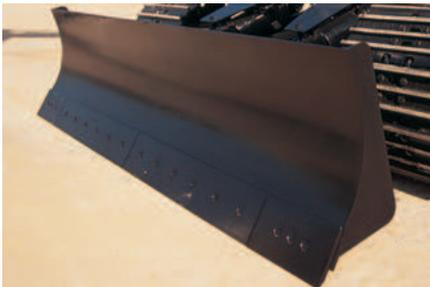
**Hojas.** Se dispone de tres anchos de hoja como accesorios. La cuchilla empernable consta de tres piezas, que puede reutilizarse volteándolas. Dispone de cuchillas empernables que protegen la hoja contra los daños y el desgaste. Los cojinetes de malla en las juntas de los pasadores del cilindro de la hoja prolongan el intervalo de engrase.
