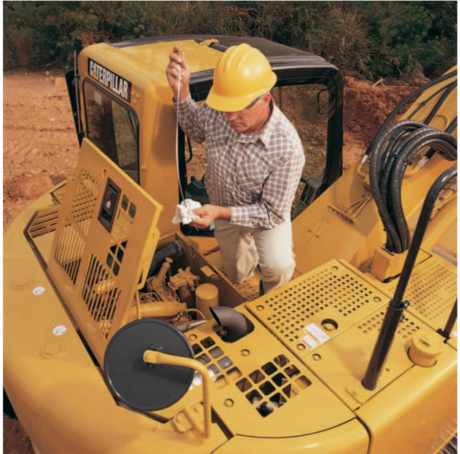
**Tanque de combustible.** Tiene una válvula de drenaje en el fondo del tanque, haciendo que sea más fácil eliminar el agua y los sedimentos durante el mantenimiento.
