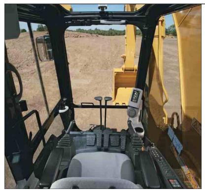
Fahrerkabine. Im Innenraum der Kabine dominieren Ergonomie und Komfort. Alle Bedienelemente befinden sich in direkter Reichweite und lassen sich mit wenig Kraftaufwand betätigen. Das neue Steuer- und Überwachungspult ist im Blickfeld des Fahrers angeordnet, ohne die Sicht zu behindern.
