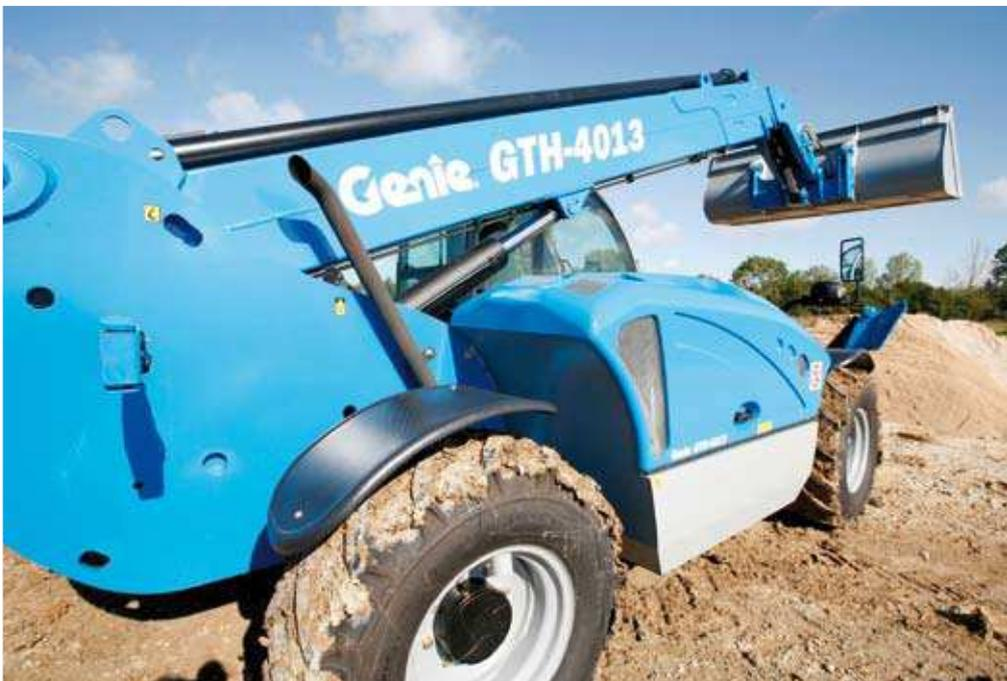
**El motor lateral permite un mantenimiento rápido con el operador pie a tierra..**
