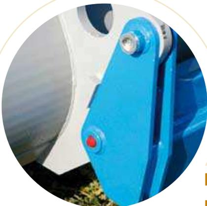
**El enganche hidráulico automático permite un cambio rápido de los accesorios desde la cabina.**
