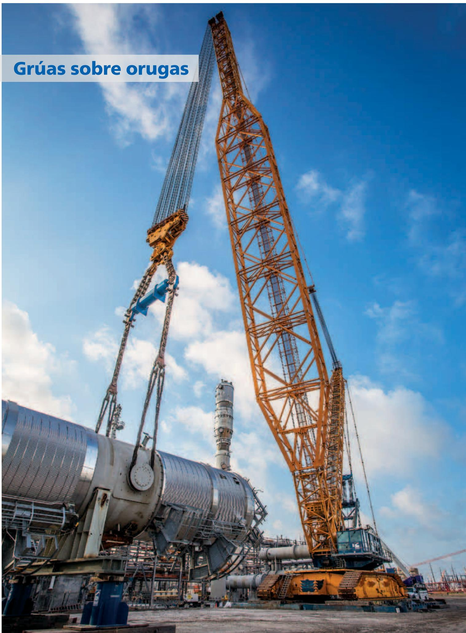
Si el trabajo exige una grúa de tamaño y potencia inusuales, piense en una grúa sobre orugas Demag. Su capacidad de elevación es superior a la de cualquier otro tipo de grúa (hasta 3200 t) y mantiene una excelente maniobrabilidad incluso con cargas pesadas. Pese a su tamaño, las grúas sobre orugas Demag son fáciles de transportar y, una vez en el lugar de la obra, se instalan rápidamente. Soluciones innovadoras y exigentes normas de seguridad le ofrecen la grúa perfecta para cada aplicación.
