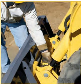
Il sistema Ghel All-Tach e' compatibile con quasi tutti gli accessori di pale compatte di quasi tutti i fabbricanti, si connettono e disconnettono con molta facilità.
