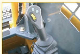
Hydraglide e regolano la portata dell'olio. Il pulsante giallo attiva la funzione di regolazione automatica della portata dell'olio in proporzione al carico.
