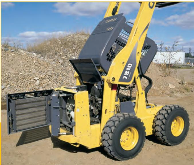
Il sistema idraulico ausiliario di alta portata fornisce fino a 155 litri/ min. per supportare accessori di alto rendimento.
