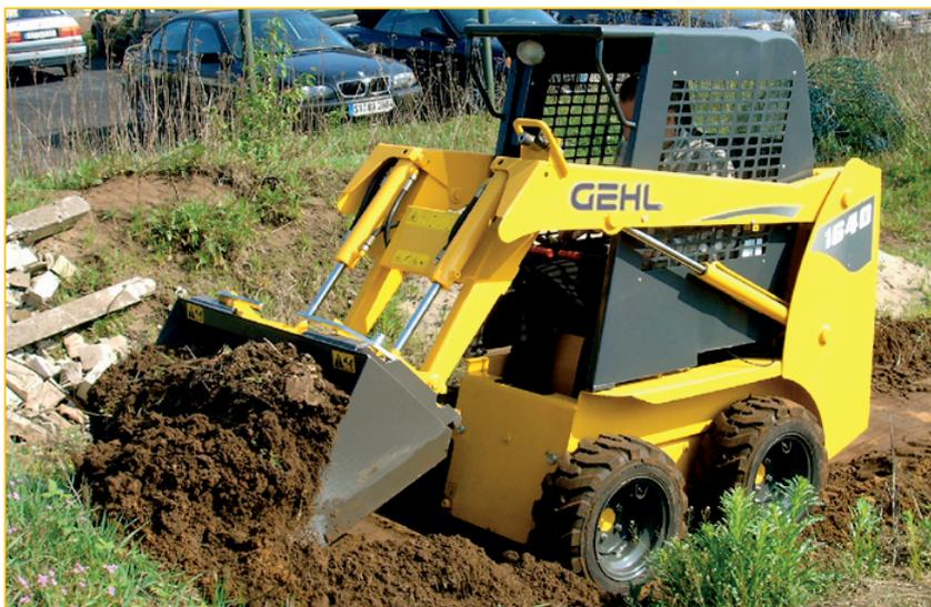
Questa piccola pala compatta fornisce all'utente lo stesso confort che ci si aspetta dai mezzi più grandi: eccellente visibilità dovuta al disegno particolare dei bracci Power-View, una guida uniforme grazie ad un passo allungato, leve di controllo confortevoli e meno faticose da manovrare, braccioli, cinture di sicurezza regolabili ed arrotolabili, basso livello di rumorosità e di vibrazioni in cabina, serbatoio carburante con chiusura e pulsante di stacco batteria.
