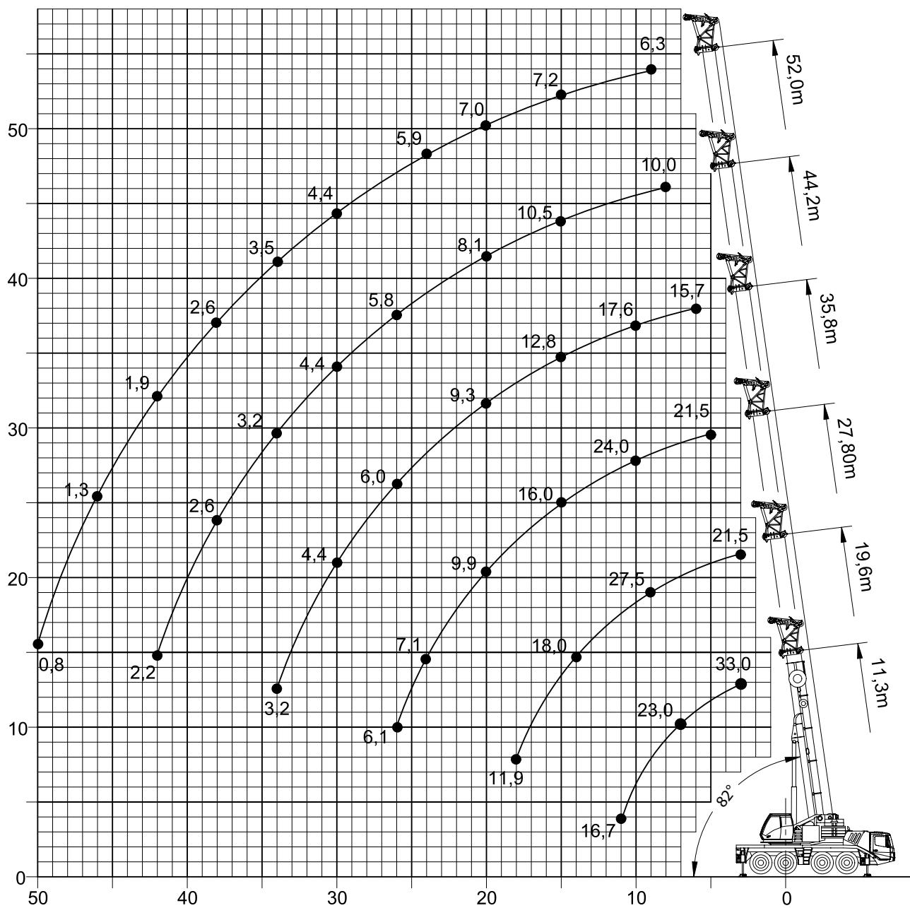
Load charts • Traglasten • Capacités de levage
