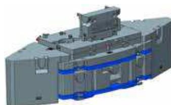
Ses configurations de contrepoids permettent de faire varier l'installation entre 1 t de contre-poids et de 12 t à 16,5 t par essieu en configuration taxi. Vous obtenez ainsi une meilleure maniabilité et traction sur route et réalisez des économies de déplacement.
