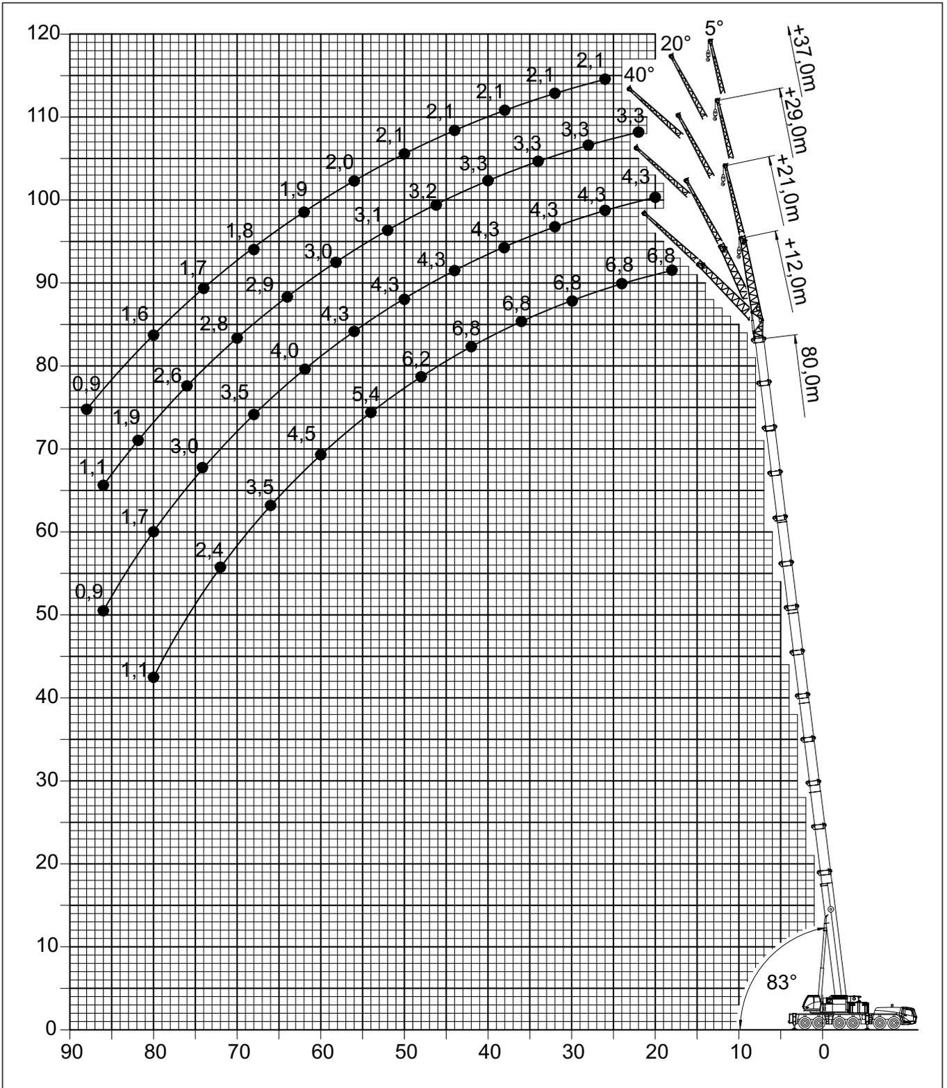
Jib configurations • Configuraciones de plumín • Configurações do jib
