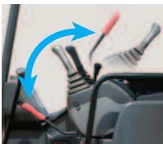
Tutte le funzioni—avanzamento, brandeggio, traslazione escavo—possono essere inibite bloccando la valvola di neutralizzazione del circuito pilota. Ciò permette di prevenire in modo efficace azionamenti accidentali delle leve di comando.
