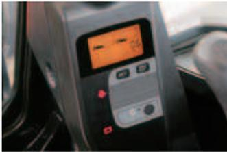
L'operatore può tenere costantemente sotto controllo le condizioni della macchina con una semplice occhiata. Livello dei carburante, temperatura del fluido di raffreddamento e stato degli altri indicatori, sono chiaramente visualizzati sull'ampio display LCD posto sul lato anteriore destro.
