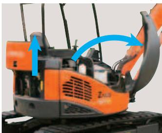
E' possibile far scorrere verso l'alto e verso il basso il cofano del motore per velocizzare la manutenzione anche in spazi ristretti. In questo modo si eliminano aperture laterali che ostacolano i lavori di manutenzione. La parte destra del cofano può essere sollevata lateralmente per un rapido controllo della batteria.
