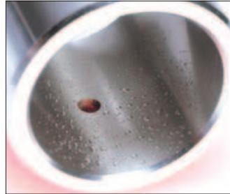
Su ciascun perno di articolazione frontale sono installate boccole HN originali Hitachi, ben collaudate sul campo, in modo da ridurre sia le vibrazioni che la necessità di manutenzione. Gli intervalli di lubrificazione si estendono fino a 500 ore.
