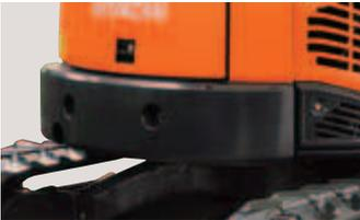
In caso di utilizzo di un accessorio anteriore molto pesante come un sollevatore a forza, è possibile installare facilmente il contrappeso supplementare per aumentare la stabilità della macchina.
