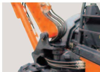
I flessibili anteriori con sezione sdoppiata sono collegati alle prese sul cofano della macchina e sul retro del braccio per una facile sostituzione.
