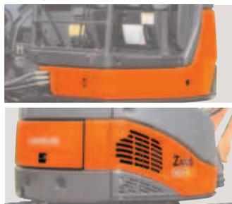
Per impieghi gravosi viene utilizzata una copertura in acciaio che consente una facile riparazione in caso di danni. Tale copertura in acciaio ha un'elevata durata, è riciclabile ed economica.
