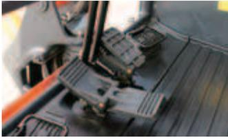
Mentre controlla la marcia del veicolo con i pedali, l'operatore è in grado di comandare l'accessorio anteriore con i comandi manuali. Quando i pedali non sono utilizzati, è possibile ripiegarli in modo da aumentare lo spazio per i piedi.
