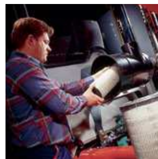
El filtro de aire está fácilmente accesible debajo del capó.
