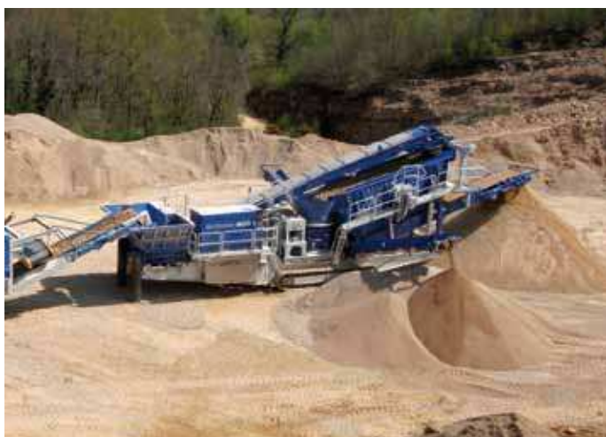
MCO 9 S w obiegu zamkniętym produkuje trzy typy wysokiej jakości kruszywa.
