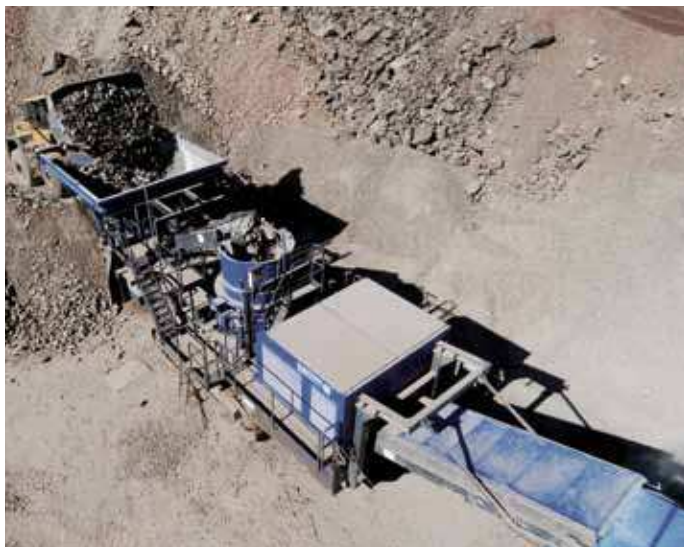
MCO 11 może być także zasilana przy pomocy ładowarki kołowej.
