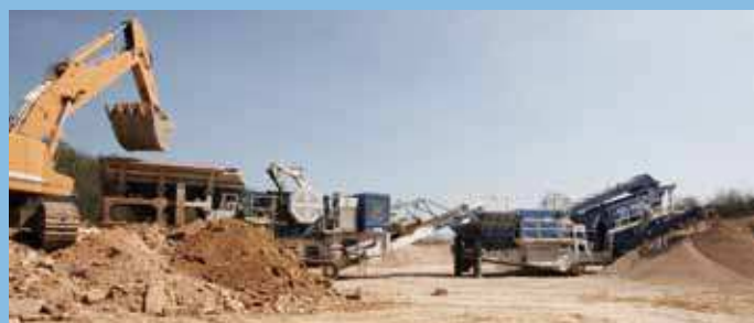
Maszyna MCO 9 S jest zasilana bezpośrednio przez mobilną kruszarkę szczękową typu MOBICAT MC 120 Z firmy Kleemann.
