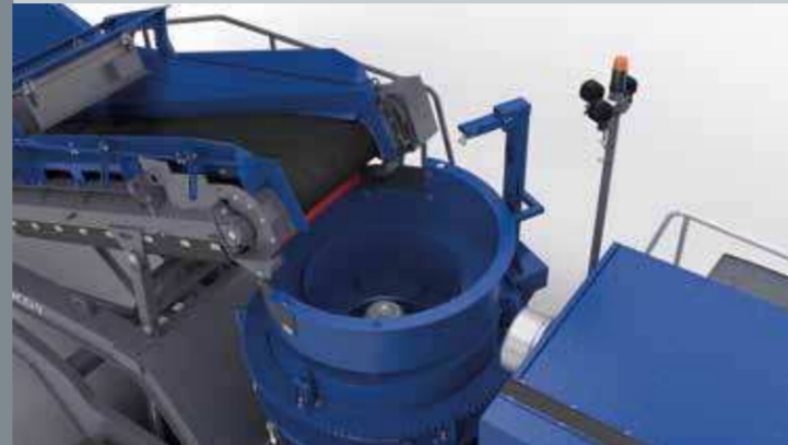
Optimización del nivel de llenado de la machacadora gracias al CFS
