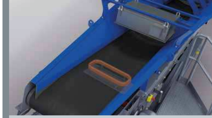
Magnet und Metallsuchgerät für beste Betriebssicherheit
