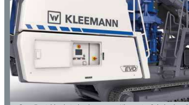
Gute Erreichbarkeit durch separate Klappe im Schaltschrank
