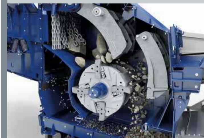
Brechereinheit mit optimierter Einlaufgeometrie
