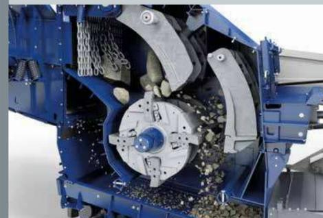
Broyeur à géométrie optimale
