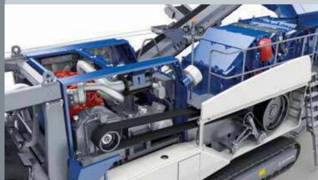
Entraînement direct du broyeur par coupleur hydraulique
