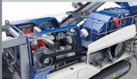
Azionamento diretto del frantoio tramite giunto idraulico
