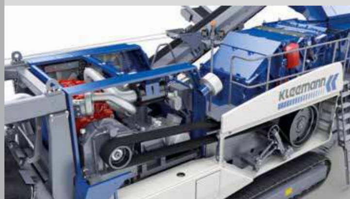
Acionamento direto do britador por meio de acoplamento de fluido
