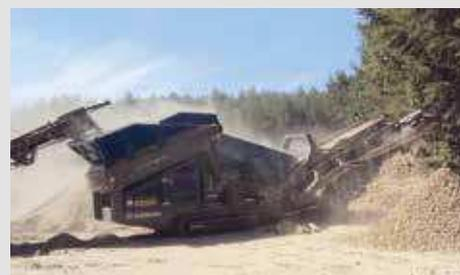
**Grande trémie d'alimentation** pour une grande flexibilité lors du chargement par chargeuse sur pneus ou par pelle
