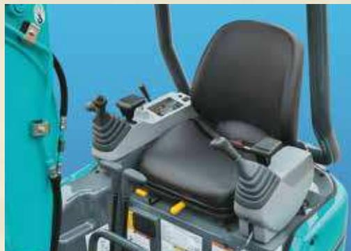
Drei-Säulen-Schutzdach gemäß ROPS und FOPS, Stufe 2
