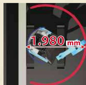
Der SK175R bietet größere Schwenkwinkel von 65 Grad nach links und 55 Grad nach rechts. Der Mindestschwenkradius mit nach links geschwenktem Ausleger beträgt nur 1.320 mm und die Arbeitsbreite bei einer 180-Grad-Schwenkung beträgt nur 1.980 mm. Durch diesen kurzen Schwenkbereich eignet sich der Bagger gut zum Graben, Schwenken und zur LKW-Beladung, wenn nur 2 m Platz zur Verfügung steht.
