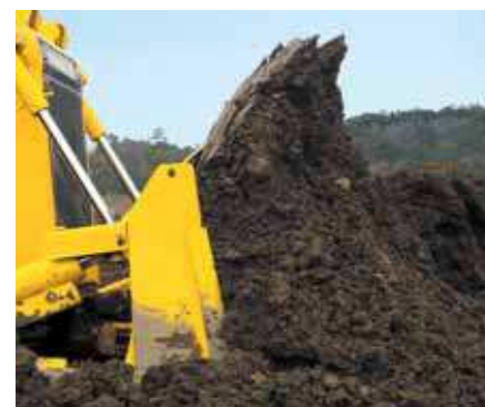
La hoja Sigmadozer® ofrece una mayor capacidad de rodado del material.
