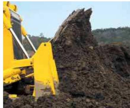
La lame Sigmadozer® offre une plus grande capacité de matériau à déplacer
