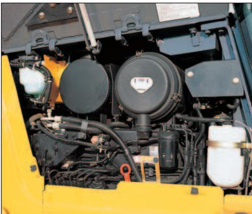
Ein Kühlwasser-Ausgleichsbehälter erleichtert die Kühlwasserstandkontrolle und vermeidet häufiges Nachfüllen.
