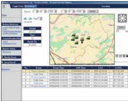
Verfolgung des Maschinentransports – Wird die Maschine transportiert, sendet KOMTRAX™ Meldungen über die Standortwechsel der Maschine auf die Internetseite oder per E-Mail an einen registrierten Nutzer und bestätigt am Ende das Erreichen des Zielorts.
