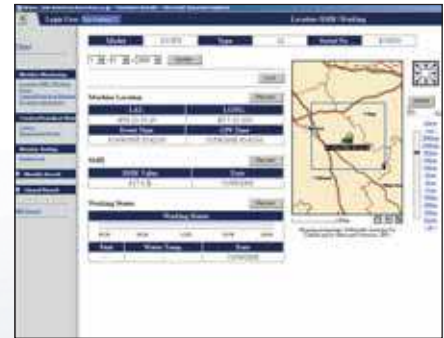
Gesteigerte Sicherheit – Mit Hilfe der Motorsperrfunktion lässt sich festlegen, in welchen Zeiträumen die Maschine gestartet werden kann. Die Geofence-Funktion benachrichtigt den Maschinenbesitzer, sobald die Maschine einen festgelegten Einsatzbereich verlässt.
