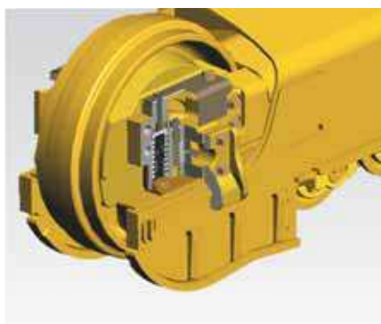
Vodící kolo s automatickým napínáním pásu
