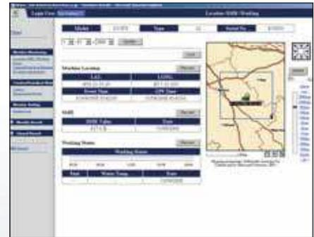
*Aumento de segurança – O “bloqueio do motor” é uma característica que permite programar quando a máquina pode ser colocada em funcionamento. E com as zonas geográficas defensivas o KOMTRAX™ envia notificações sempre que a máquina se mova para fora da zona determinada.*
