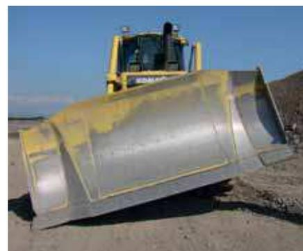
Inclinação hidráulicamente ajustável: 870 mm
