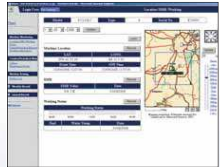
Ytterligere sikkerhet – “Start sperren” tillater programmering for når en maskin kan startes. Og med “geo-fence” kan KOMTRAX™ sende meldinger hver gang din maskin forflytter seg ut av det forutbestemte området.
