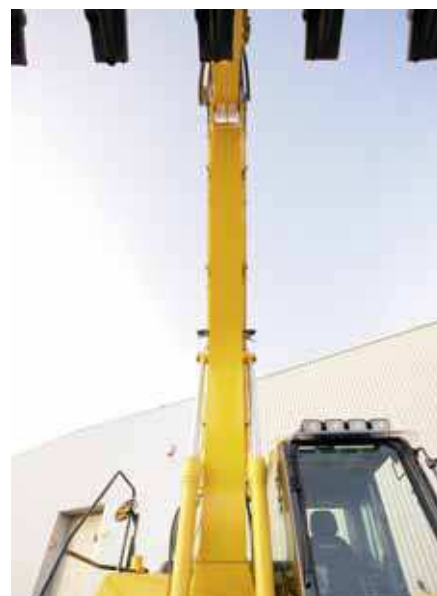
Ściany wysięgnika z jednego kawałka blachy
