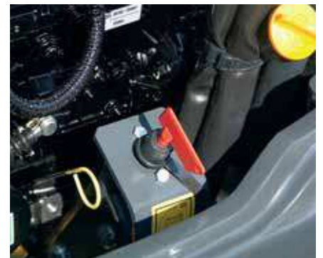
Coupe circuit de l'installation électrique en standard
