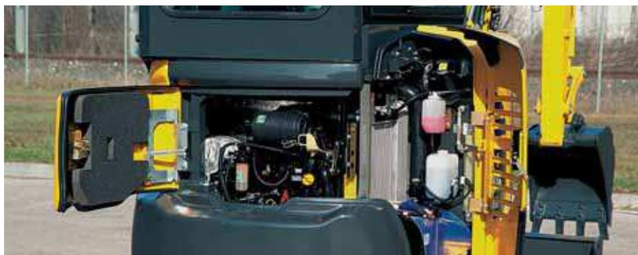
Capotas traseiras para verificações ao motor, abastecimento do combustível, inspeções simples, limpeza dos radiadores e acesso às baterias
