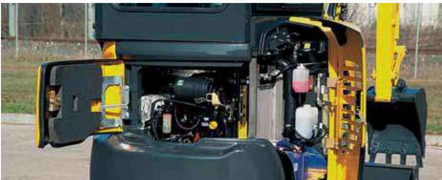
Avattavien luukkujen ansiosta moottorin tarkastus ja polttoaineen lisäys on nopeaa, jäädytintä on helppo tarkastaa ja puhdistaa, akut saa helposti esille
