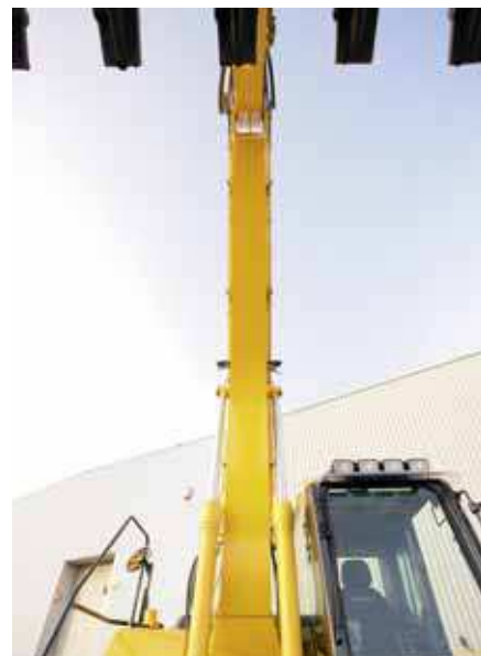
Topo e base da lança de uma peça inteira
