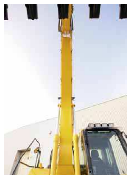
Ściany wyciągnika z jednego kawałka blachy
