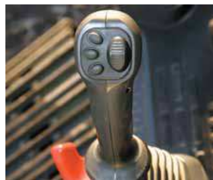
Joysticki z przyciskami proporcjonalnego sterowania sprzętem
