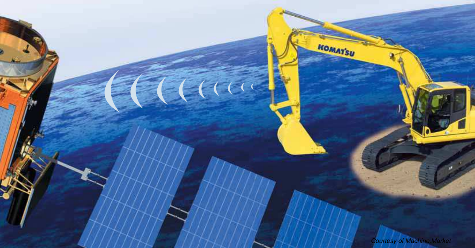
Ytterligere sikkerhet – “Start sperren” tillater programmering for når en maskin kan startes. Og med “geo-fence” kan KOMTRAX™ sende meldinger hver gang din maskin forflytter seg ut av det forutbestemte området.
