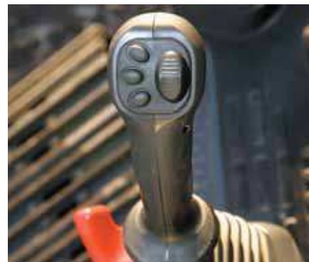
Gravespaker med brytere for proporsjonalstyring av redskaper
