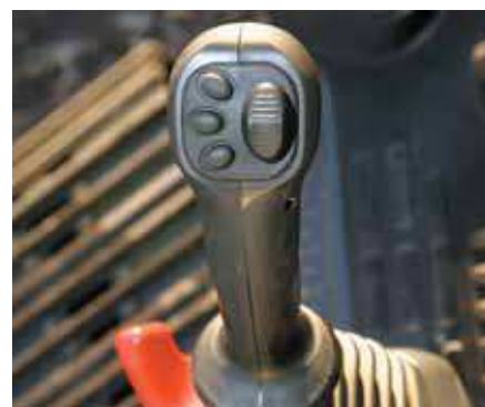
Grävspakar med proportionell kontrollknapp för redskap
