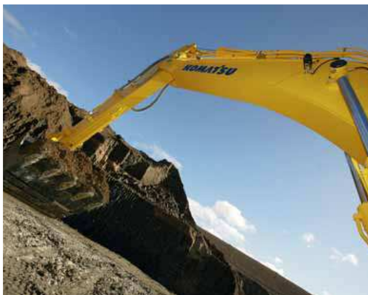
Topo e base da lança de uma peça inteira
