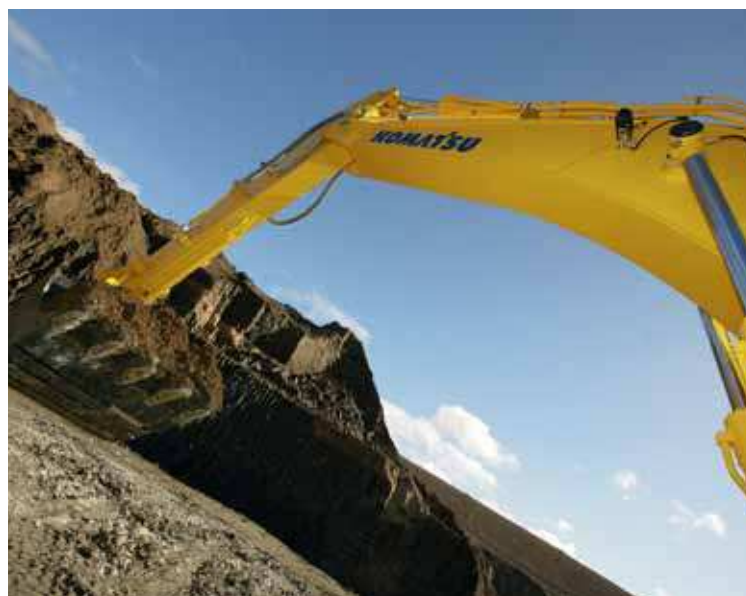
Ściany wysięgnika z jednego kawałka blachy
