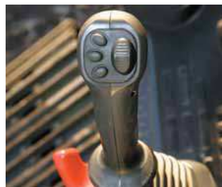
Ovládací joysticky s tlačítky pro proporcionální ovládání příslušenství
