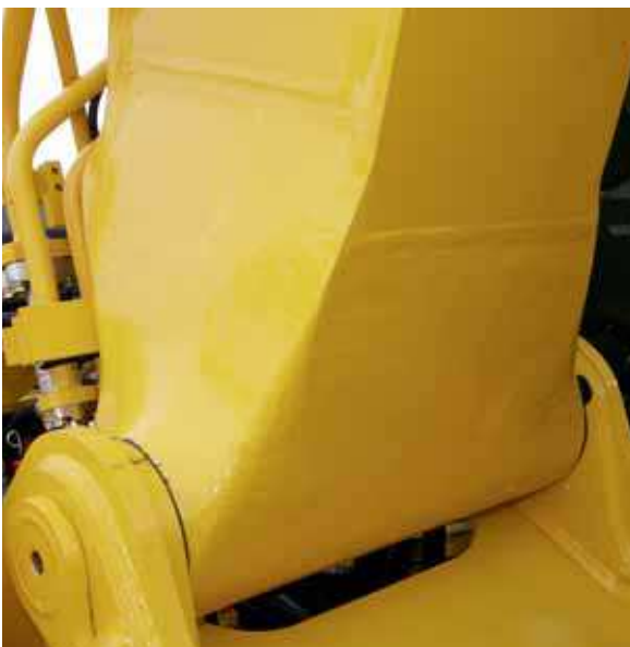
Auslegerfuß aus Stahlguss
