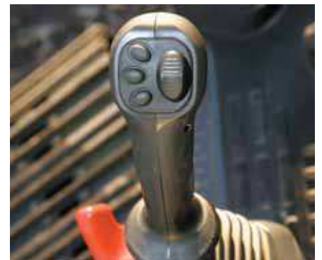
Joysticks mit Proportionalsteuerung für Anbaugeräte
