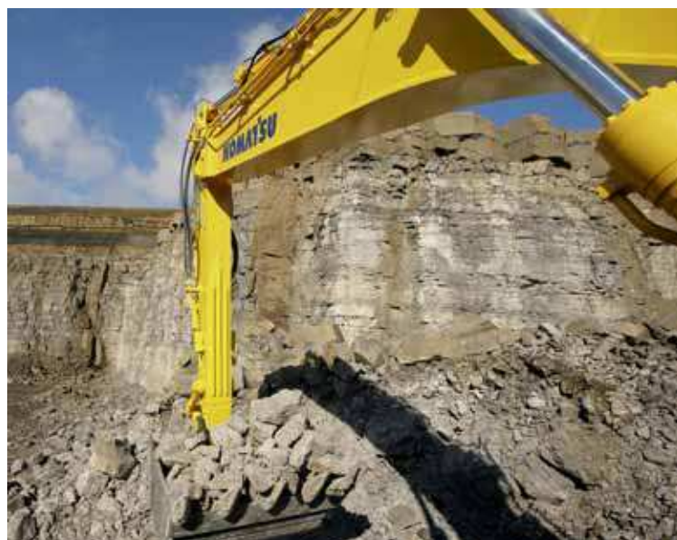
Ściany wysięgnika z jednego kawałka blachy
