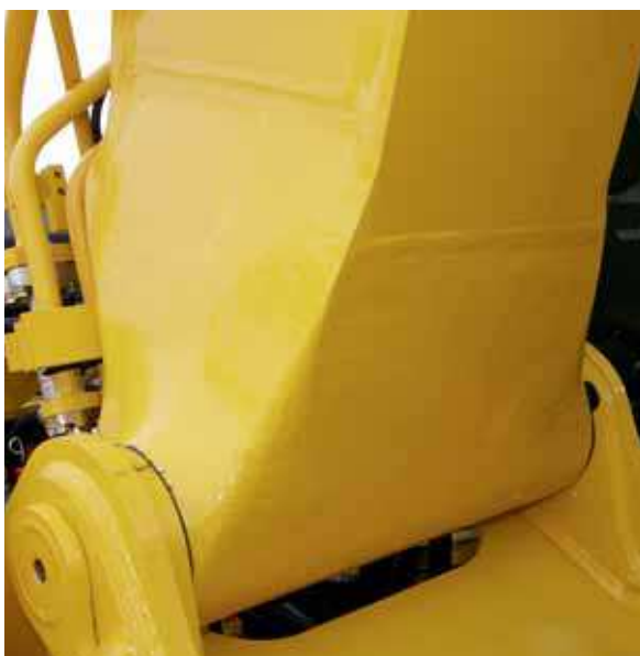
Base del braccio in fusione d'acciaio
